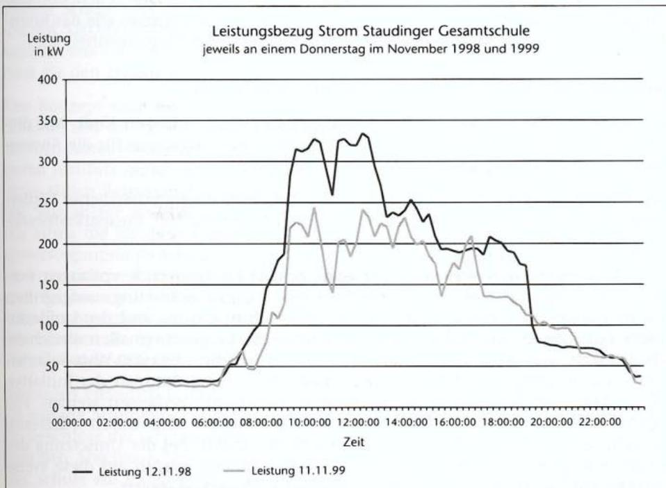
Abb. 13: Leistungsbezug Strom vor und nach der Sanierung
